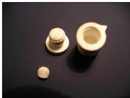
Figure 3-15. Aspect de l'échantillon après ouverture du creuset RMN (37%mol AlF 3 ).
