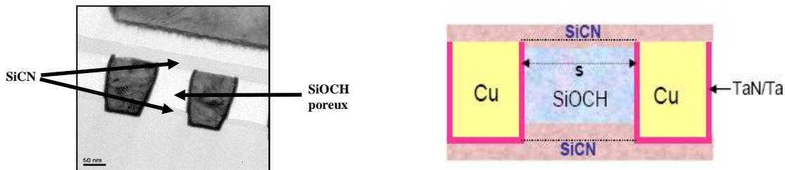
Figure V-3 : Coupe TEM d'une structure de test étudiée et schématisation.
