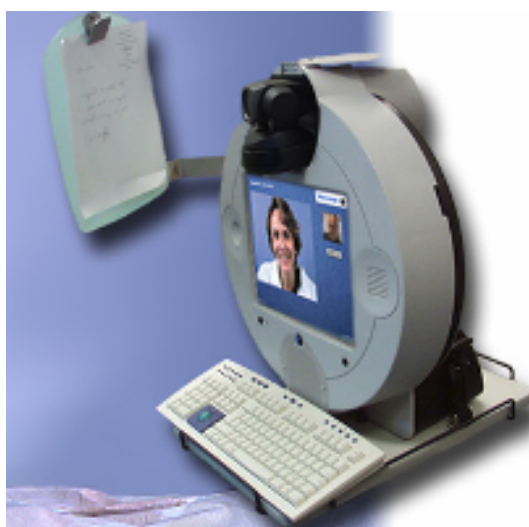
Figure 34- Poste périphérique du système vidéoconférence (station patient)
