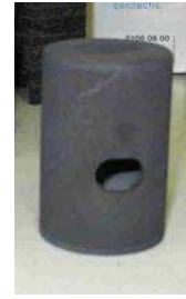
Figure 5-6: Élément chauffant VITI (suscepteur)
