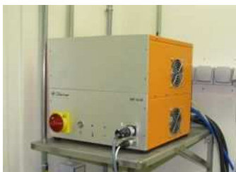
Figure 5-3: Générateur VITI - 24 kWatt - Fréquence : 23 kHz
