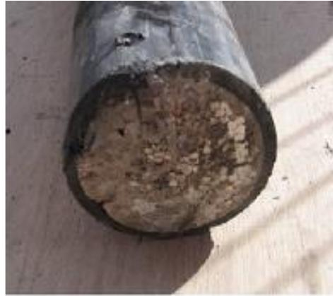
FIGURE 1.8 – Coupe d'un conduit de précontrainte
