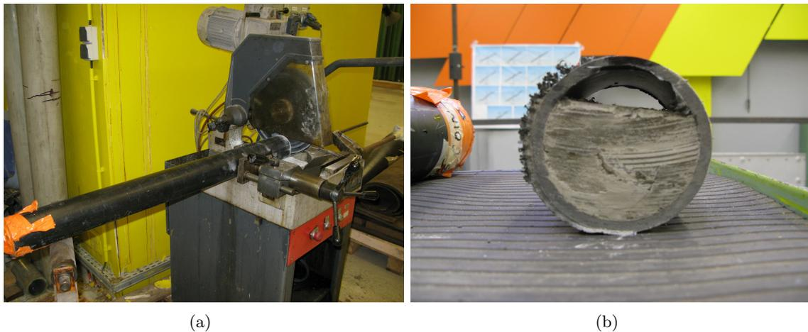
FIGURE 5.12 – *Découpe du conduit et profil intérieur pour la section à 82 cm*
