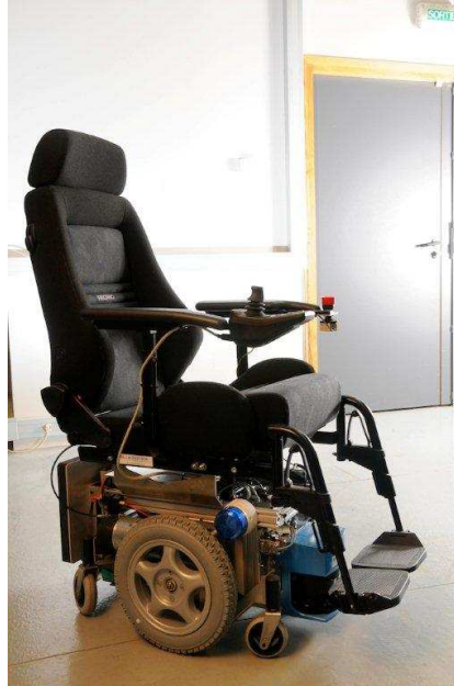
FIGURE 5.1 – Chaise roulante automatisée utilisée lors des expérimentations de l’approche de déformation de trajectoire Teddy.
