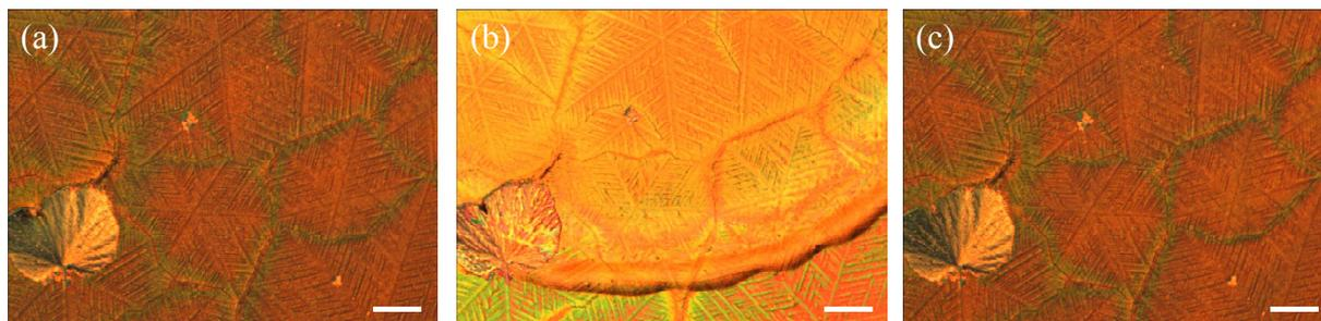
**Figure 2 :** Influence d'une goutte de *n*-heptane déposée sur un film de CLC PePEG orienté en ancrage homéotrope : (a) Avant dépôt de *n*-heptane ; (b) Dépôt d'une goutte de *n*-heptane ; (c) Après dépôt de *n*-heptane. La texture optique des clichés (a) et (c) est similaire, indiquant que le *n*-heptane est sans influence sur l'organisation du CLC PePEG. La barre d'échelle indique 200  $\mu\text{m}$ .
