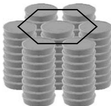
**Figure 7 :** Représentation schématique d'une phase cristal-liquide colonnaire hexagonale.
