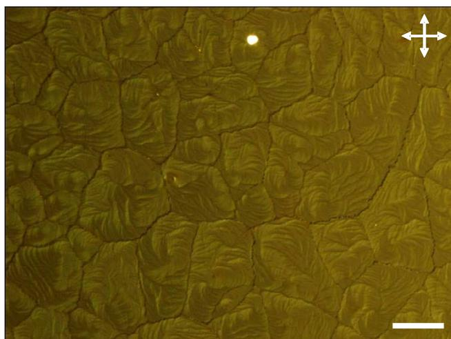
**Figure 29 :** Cliché d'un film mince de composé intermédiaire  $Bp_{0.75}Pe_{0.25}$  pris après recuit en microscopie optique polarisée (les polariseurs ont été légèrement décroisés et le contraste accentuée pour une meilleure visibilité). La texture non-biréfringente observée est caractéristique d'un ancrage homéotrope d'un CLC. La barre d'échelle indique 100  $\mu\text{m}$ .
