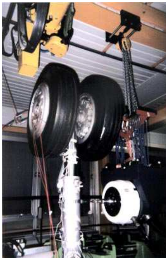
FIG. 6.4 – Montage expérimental pour l'excitation de direction Y.
