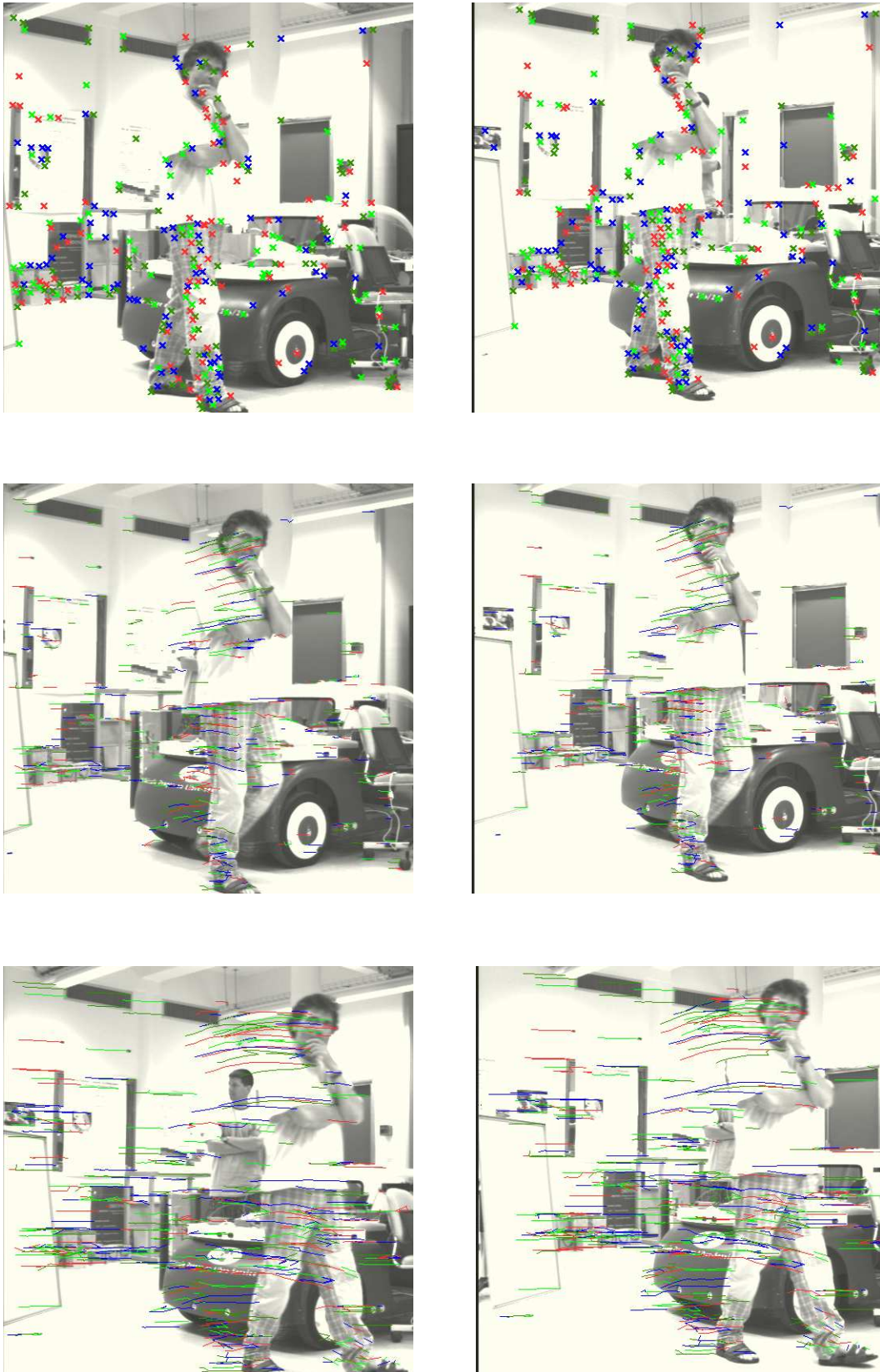
FIG. 3.4: Séquence stéréoscopique 1. Ligne 1: 306 points extraits et mis en correspondance dans la paire stéréo 1. Ligne 2: points poursuivis jusqu'à la paire stéréo 7. Ligne 3: points poursuivis jusqu'à la paire stéréo 20.
