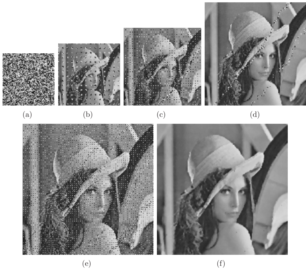
Figure 4.10 – (a-e) Reconstruction progressive de Lena avec pertes de paquets : la première couche (a) n'est pas transmise, un paquet de 100 points est perdu pendant la transmission de chaque couche restante (b-e). (f) Restauration de (e) à l'aide d'un filtre médian 3 \times 3 .
