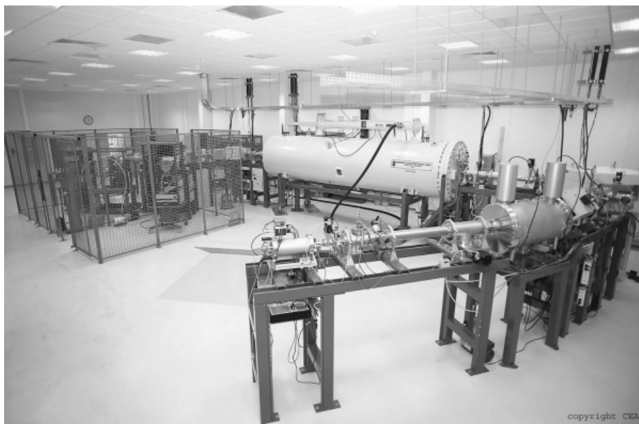
Figure II-3 : Matériel utilisé pour la mesure des niveaux de 14 C dans l'aérosol carboné. Source : http://www-lmc14.cea.fr/
