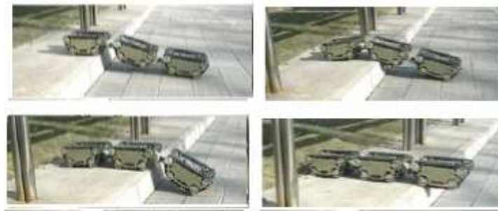
FIG. 2.7 – Un système modulaire pendant le franchissement d'un trottoir
