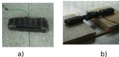
FIG. 2.6 – a) : Système modulaire : un module, b) : Système modulaire : trois modules
