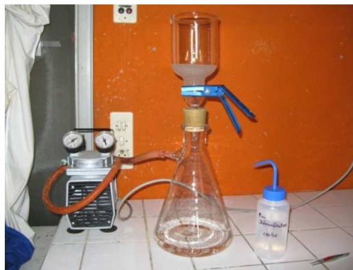
Figure A 25 : Récupération de \text{BaSO}_4 par filtration
