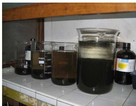
Figure A 22 : Décantation de \text{MnO}_2 dans les béciers.
