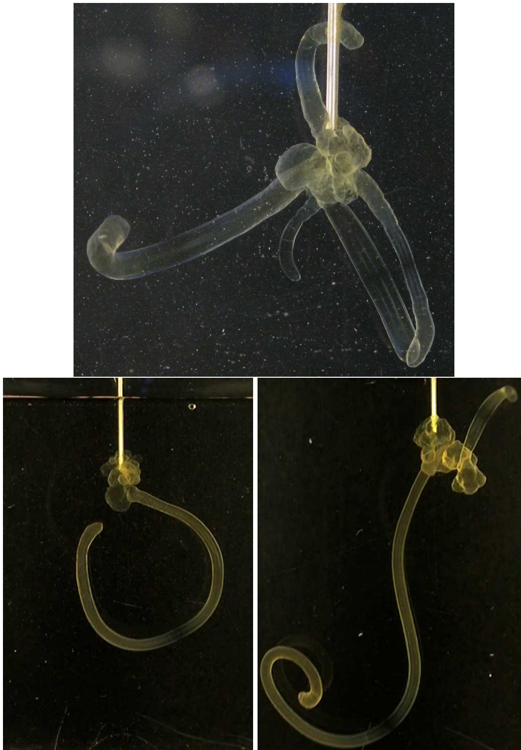
Fig. 2.10 – Morphologies de précipités après quelques secondes. c = 65\text{g/L} , Q_{inj} = 8\text{mL/min} . On voit clairement les zones où le précipité est moins dense au milieu des tubes en croissance. Les traits longitudinaux le long des tubes, visibles surtout sur les tubes de droite de la photographie du haut, sont le reflet des néons utilisés pour éclairer l'expérience.
