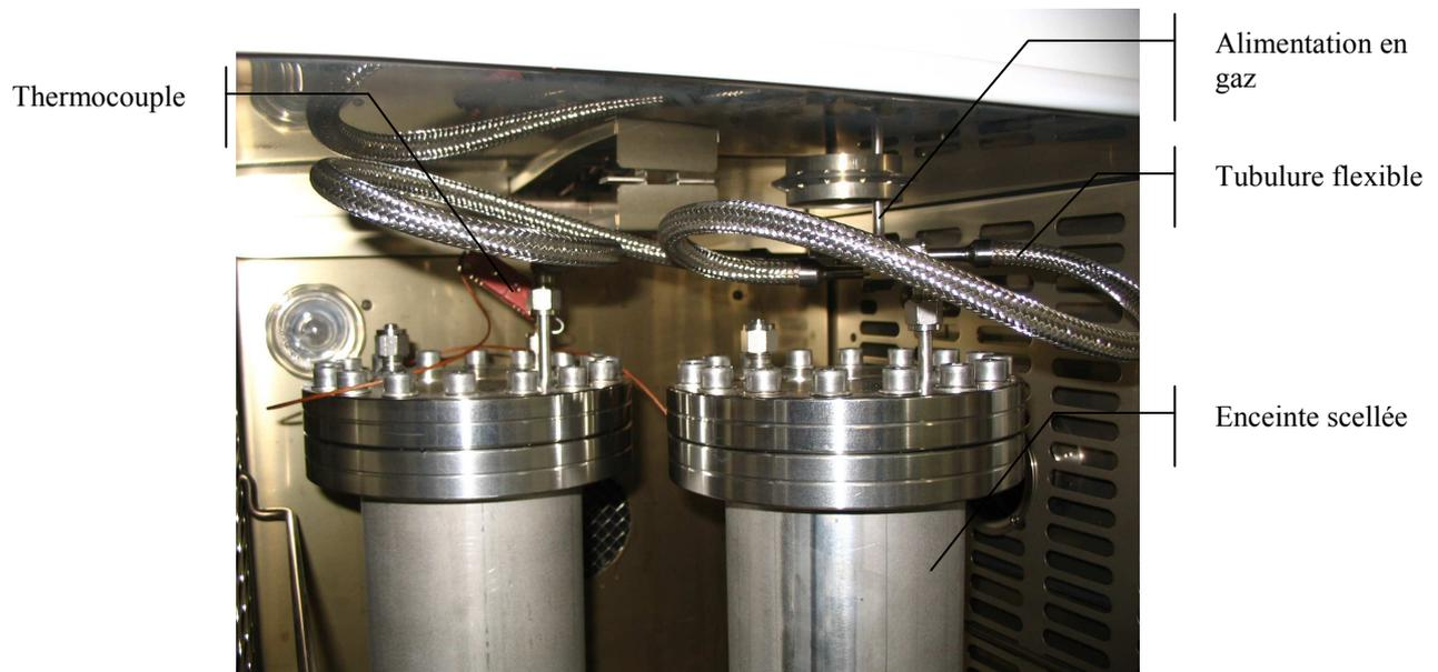
**Figure 17 : Montage des enceintes de vieillissement dans l'étuve programmable. Système d'alimentation par des tubulures flexibles**
