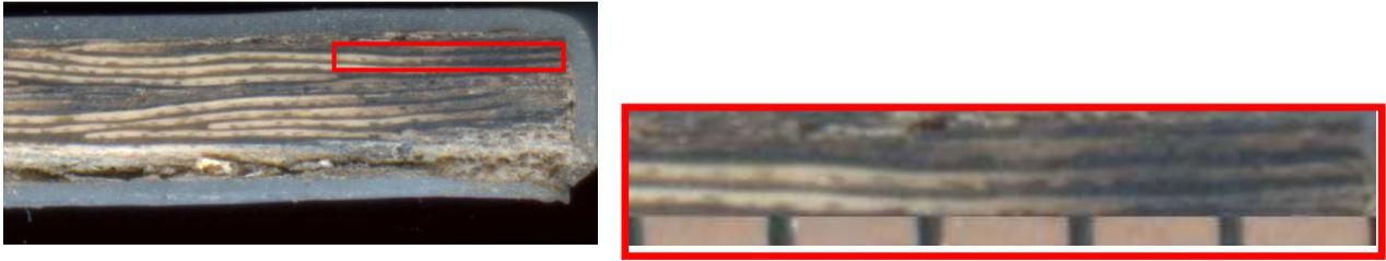
Figure 71 : Observations de la profondeur d'oxydation (hors de la fissure). Echantillon de classe F vieilli 1450 h, à 155°C sous 2,3 bars d'O<sub>2</sub>.
