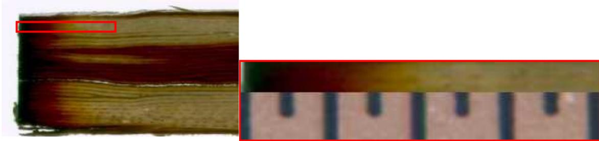
Figure 66 : Observations de la profondeur d'oxydation (hors de la fissure). Echantillon de classe F vieilli 1450h, à 155°C sous 2,3 bars d'O<sub>2</sub>.
