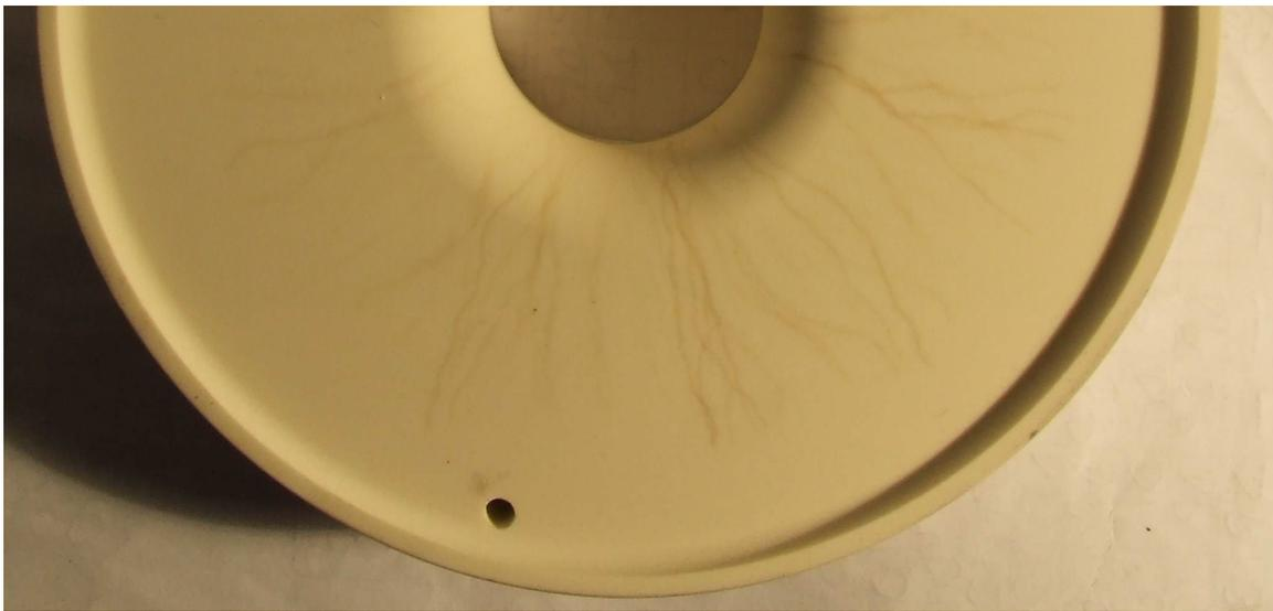
Figure 3.55. Isolant époxy ayant subi des DP et des claquages.
