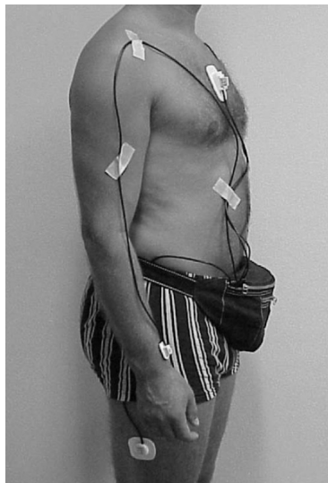
Figure 19 : Le moniteur d'activité (MA) constitué de cinq accéléromètres
