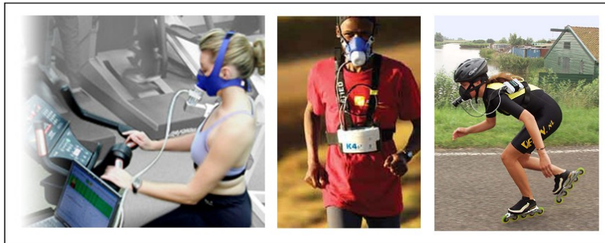
Figure 6 : Mesure des échanges gazeux en laboratoire (ergocycle) ou sur le terrain (course à pied et roller en ligne)
