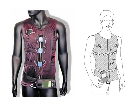
Figure 53 : Le pléthysmographe respiratoire par inductance intégré à la veste Lifeshirt ®
