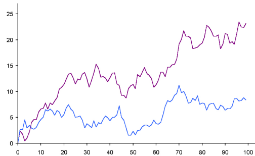
FIG. 7.6 – Dérive de l'erreur (en position et en angle) commise lors d'un suivi par points d'intérêt.
