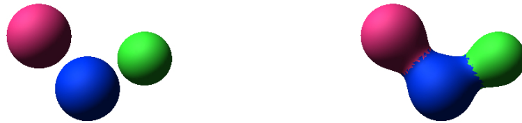
FIG. 1.14 – Exemple de surface implicite (à droite) obtenue par la fusion de trois éléments de base (à gauche).
