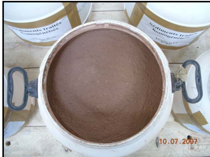
Figure 3-5. Sédiments traités fourni par Solvay après homogénéisation
