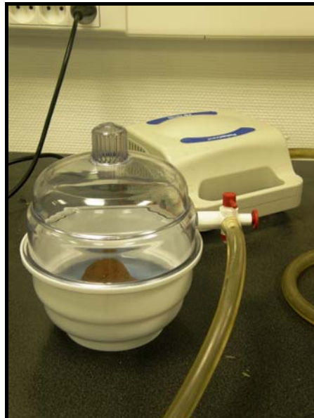
Figure 3-14. Cloche et pompe à vide pour la mesure de la porosité à l'eau ou à l'éthanol des matériaux
