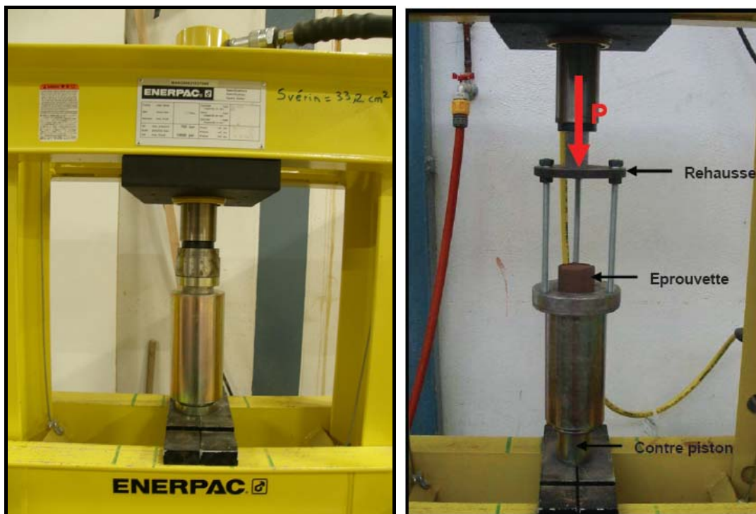
Figure 3-12. Moulage sous pression et démoulage des échantillons de NMCS
