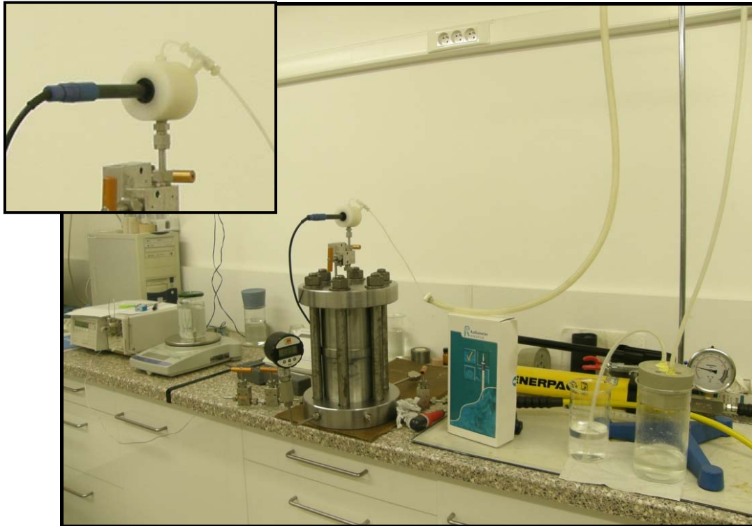
Figure 4-12. Dispositif de caractérisation par percolation ascendante sur matériaux cimentaires et cellule de circulation en plastique (en médaillon)
