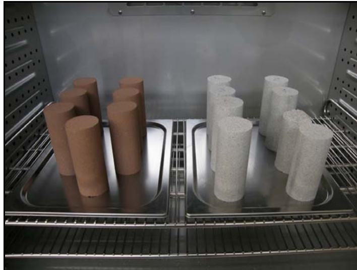
Figure 3-13. Enceinte climatique pour conserver les éprouvettes de NMCS
