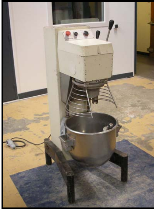
Figure 3-7. Malaxeur à vitesse variable pour la confection des matériaux routiers
