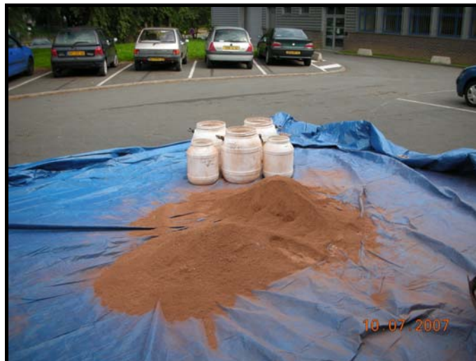
Figure 3-4. Homogénéisation des sédiments traités NOVOSOL ® : réduction de l'échantillon par quartage [AFNOR 1996]
