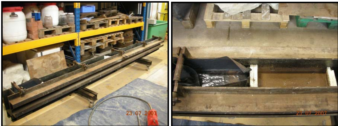
Figure 3-8. Moule métallique et les poutres de 1 er lot de matériaux routiers
