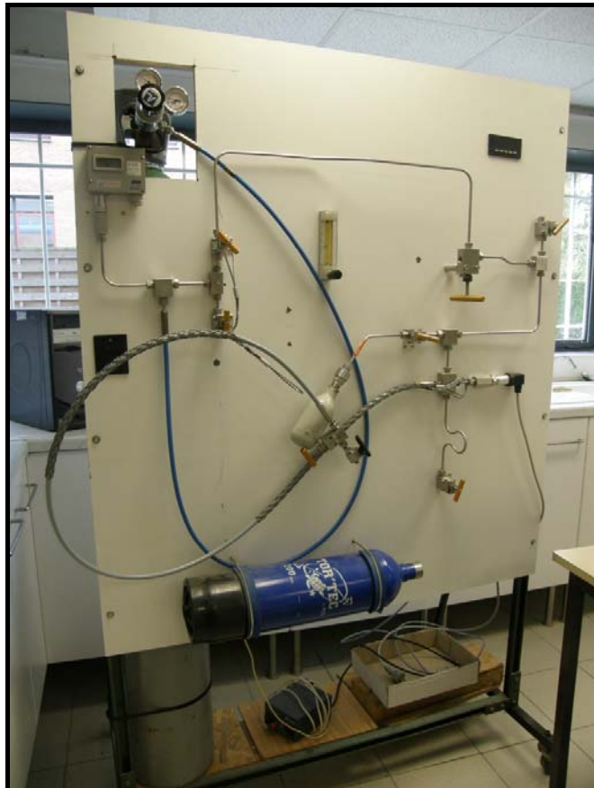
Figure 3-17. Panneau mobile utilisé pour la mesure de la perméabilité
