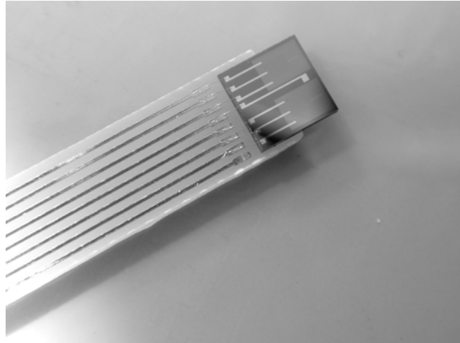
Figure II.37: Connexions par micro-soudures du composant sur le circuit imprimé.
