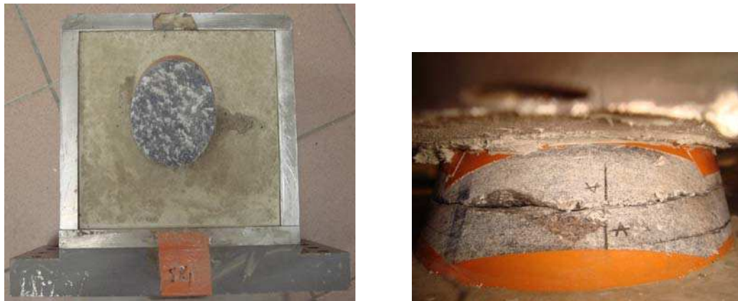
Figure 24. Exemple de joint de calcaire scellé en place, essai réalisé au LRPC de Toulouse a- vue de dessus demi-boîte inférieure uniquement, b- vue de côté, joint en place.
