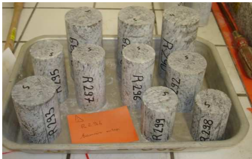
Figure 10 : Carottes de gneiss de Valabres
