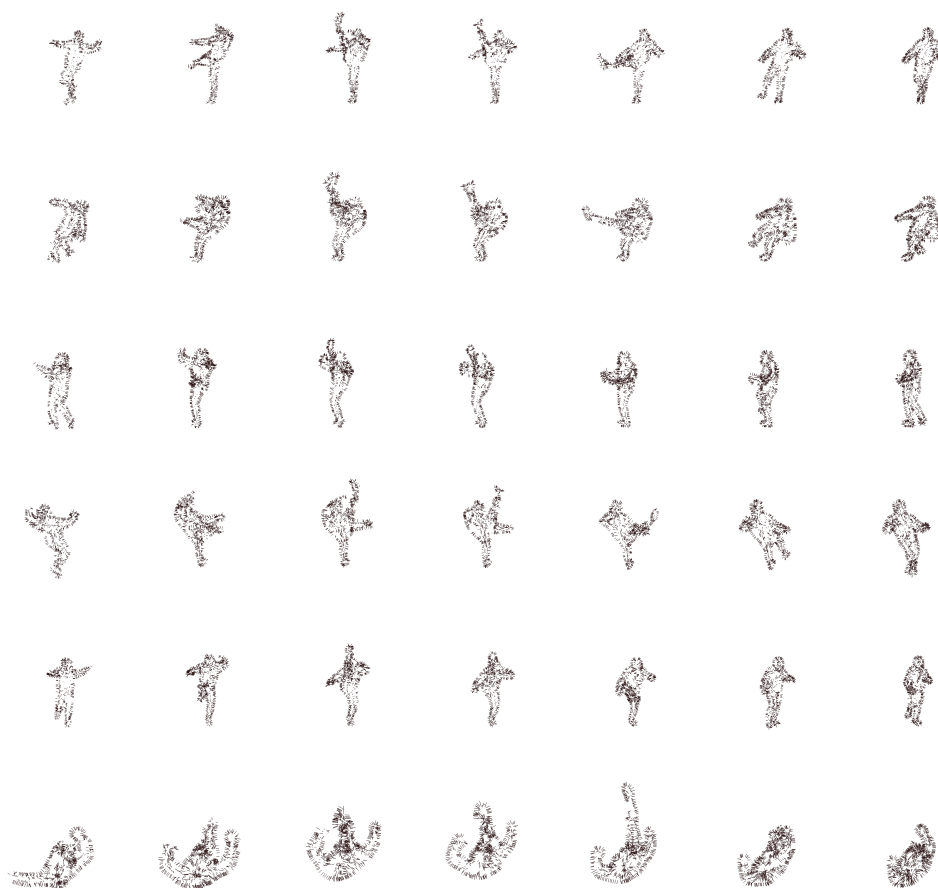
FIG. 5.3 – Les observations pour 7 trames : les points 3D et les normales à la surface, montrées suivant les 6 points de vue des caméras utilisées.
