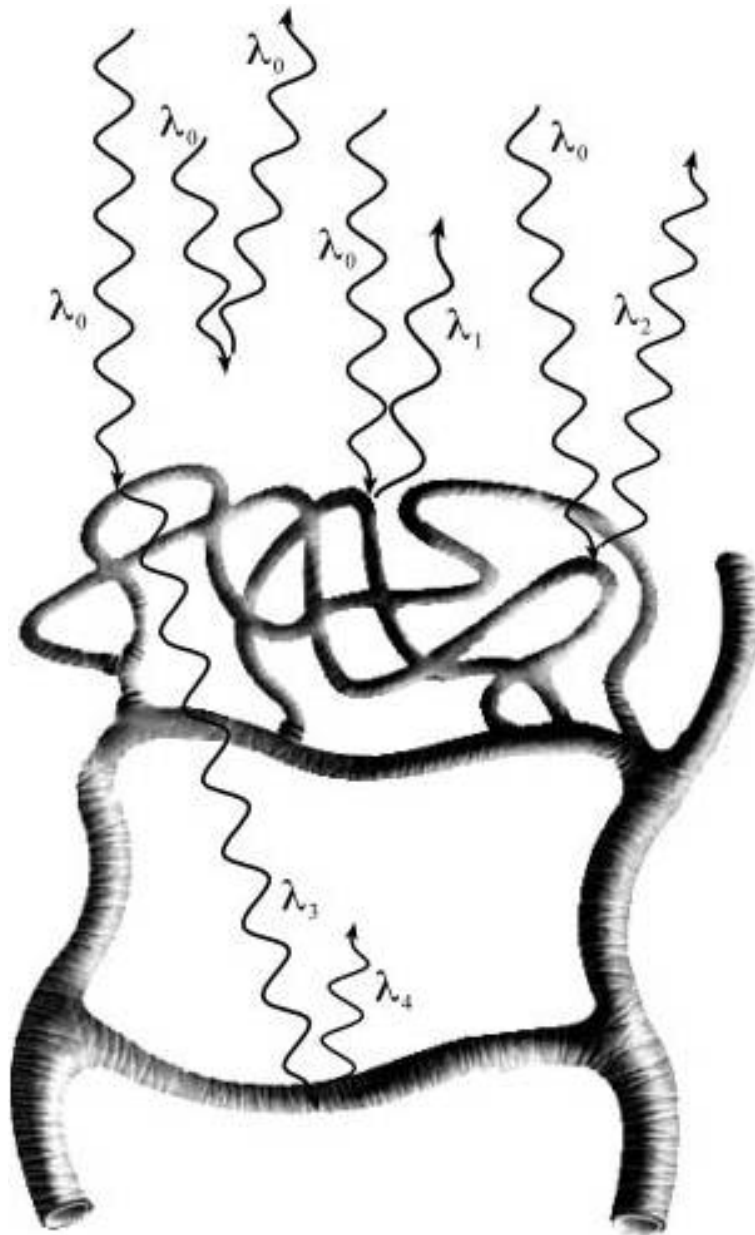
FIGURE 1.5 – Migration des photons à travers la microcirculation, impliquant un décalage en fréquence dû à l'effet Doppler, lorsque les photons rencontrent des particules en mouvement. \lambda_0 correspond à la longueur d'onde du laser tandis que \lambda_1 , \lambda_2 , \lambda_3 et \lambda_4 représentent les longueurs d'ondes après diffusion sur un objet en mouvement. Figure issue de [3]
