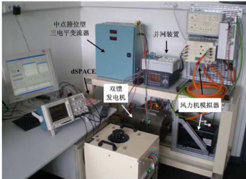
图 5.17 4.5kW 双馈风力发电系统实验平台
