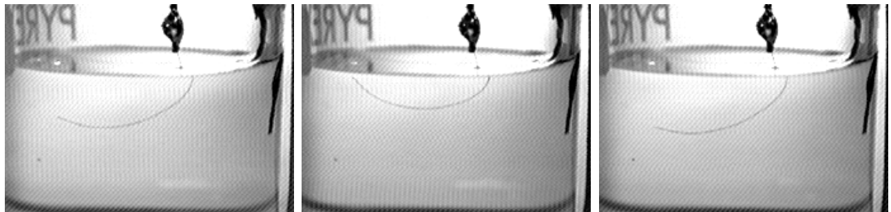
Figure IV-57 – Réponse électromécanique d'une fibre de nanotubes de carbone monoparoi dans 1 M NaCl en réponse à un potentiel périodique de 2 V pic à pic et de fréquence 1 Hz. La fibre est enduite sur la moitié de sa surface de polymère qui induit un déplacement de 1 cm environ au bout de la fibre.
