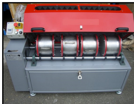
Figure 3.14 : Machine d'essais Micro Deval composée de 4 cylindres rotatifs
