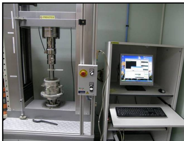
Figure 4.10 : Photographie du dispositif expérimental de détermination de l'IPI
