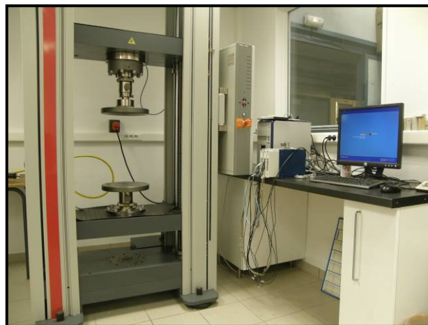
Figure 2.16 : Presse mécanique Zwick® et système d'acquisition de données
