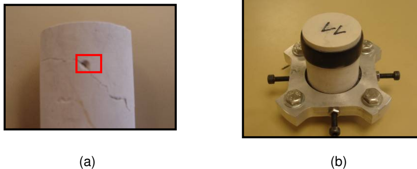
Figure 2.34 : Poinçonnement (a) et solution adaptée (b) aux tests de compression simple sur échantillons saturés
