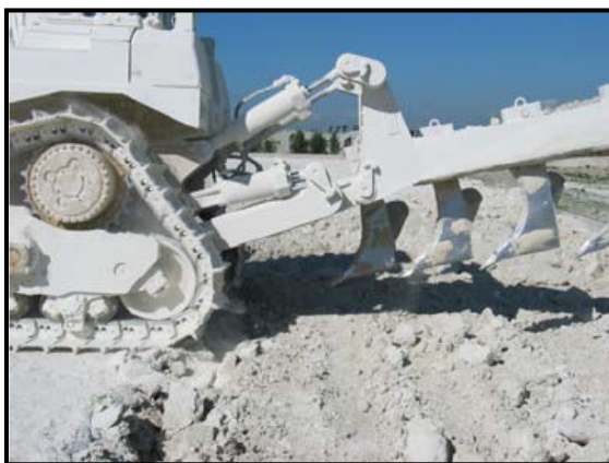
Figure 2.8 : Traitement de craie sur le chantier de la LGV Est [HENRY]
