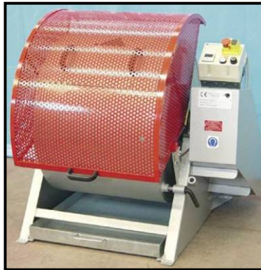
Figure 3.13 : Tambour rotatif utilisé pour un essai Los Angeles
