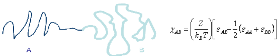
Figure I-12 : A gauche représentation schématique d'un copolymère diblocs AB, à droite expression du paramètre d'interaction entre les deux blocs A et AB
