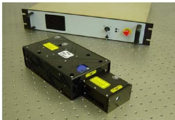
FIGURE 5.1 – Laser double cavité EC-CFR-2K utilisé et son boîtier de couplage.
