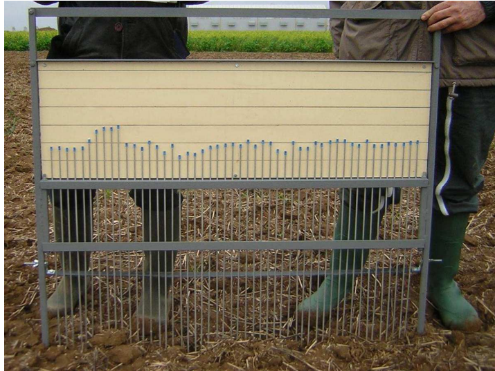
Figure 1. 8 : Photo d'un rugosimètre à aiguilles
