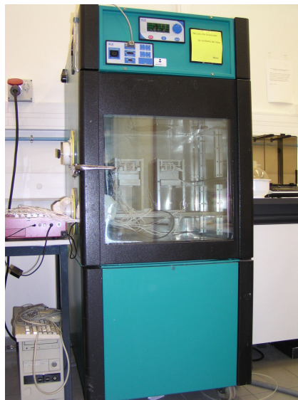
FIGURE I.28 – Enceinte climatique BIA du Laboratoire de Mécanique et Génie Civil
