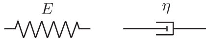
FIGURE I.8 – Ressort de rigidité E [Pa] (gauche) et amortisseur de viscosité \eta [Pa.s] (droite)
