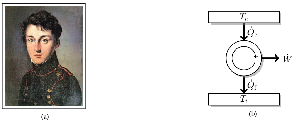
FIGURE 2.11 – (a) SADI CARNOT à sa sortie de l'École Polytechnique, en 1814. (b) Représentation symbolique usuelle de la machine de CARNOT.
