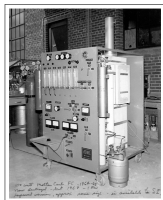
FIGURE 1.15 – (a) Pile à carbonates fondus de 1 kW électrique mis au point par Texas Instruments au début des années soixante. (b) & (c) Représentation schématique du mode de fonctionnement d'une pile MCFC alimentée en dihydrogène et en monoxyde de carbone.
