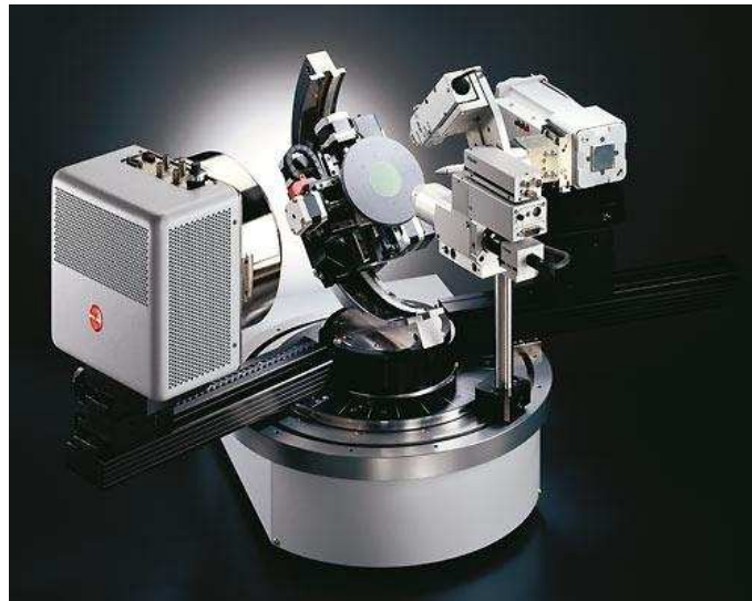
FIGURE 2.12 – Microdiffractomètre D8 DISCOVER équipé du logiciel GADDS de Bruker AXS
