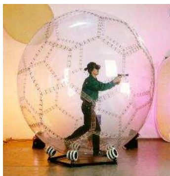
FIG. 26: Une interface pour la marche, la Virtusphere. Source : [LL06]
