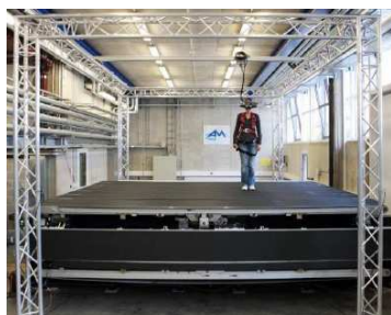
FIG. 25: Une interface pour la marche, le Cyber-walk. Source : [STU07]
