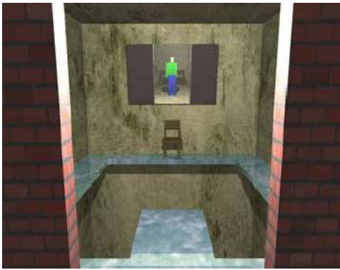
FIG. 32: Vue de la scène obtenue par lancer de rayons. On peut remarquer que le reflet de l'avatar de l'utilisateur est affiché dans le miroir au fond de la pièce. Source : [SKMY09]
