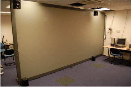
FIG. 15: Notre premier dispositif de réalité virtuelle : l'écran polarisé et quatre des huit enceintes disponibles. Source : [BCL + 06]
