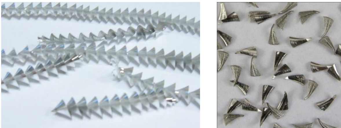
Figure I-2 : Deux types du copeau : continu et fractionné
