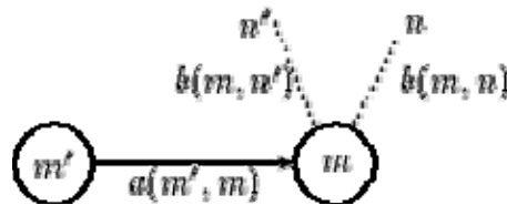
Figure 4-17 - Probabilité de transition et d'émission d'une donnée dans le modèle de Markov caché
