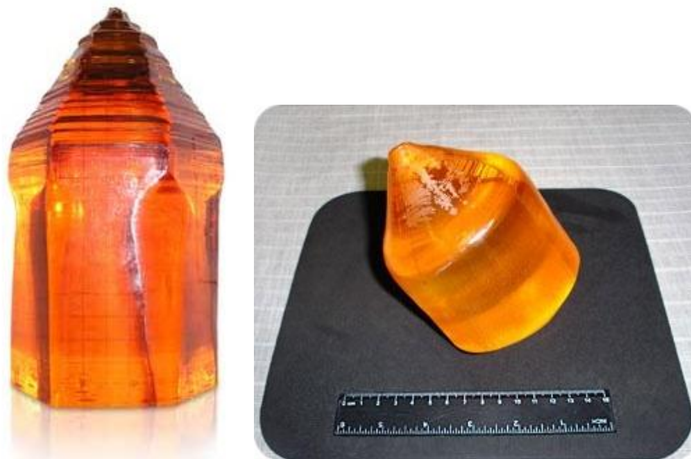
Figure 4 : Monocristal de langasite (à gauche) et monocristal de langatate (à droite) © 2010 Fomos-Materials.
