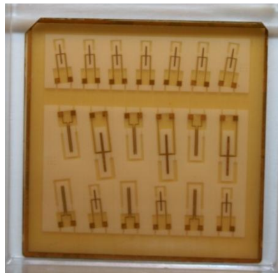
Figure 101 : Echantillon de LGS après les étapes de photolithographie avec les masques des dispositifs V3.
