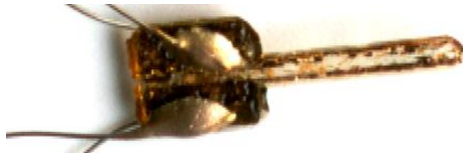
Figure 121 : Cantilever après séparation manuelle des électrodes et collage des fils.
