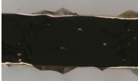
Figure 106 : Bords irréguliers d'une poutre.
