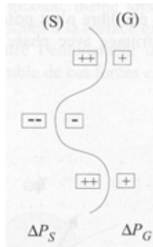
Figure 55 : Equilibre à l'interface solide-gaz et courbure Le signe (+) ou (-) indique respectivement un excès ou un défaut de pression par rapport à une interface plane [BOU 02]
