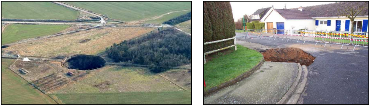
Figure I.22 : Exemples des effondrements de surface provoqués par des cavités souterraines des mines de sel (gauche) et des marnières (droite).
