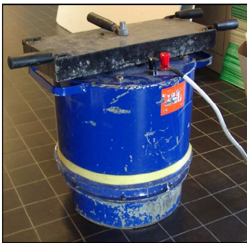
Figure III.11 : La source Vib-PA et un exemple du spectre du signal F(t) enregistré avec cette source pour un sweep linéaire 30 - 142 Hz.
