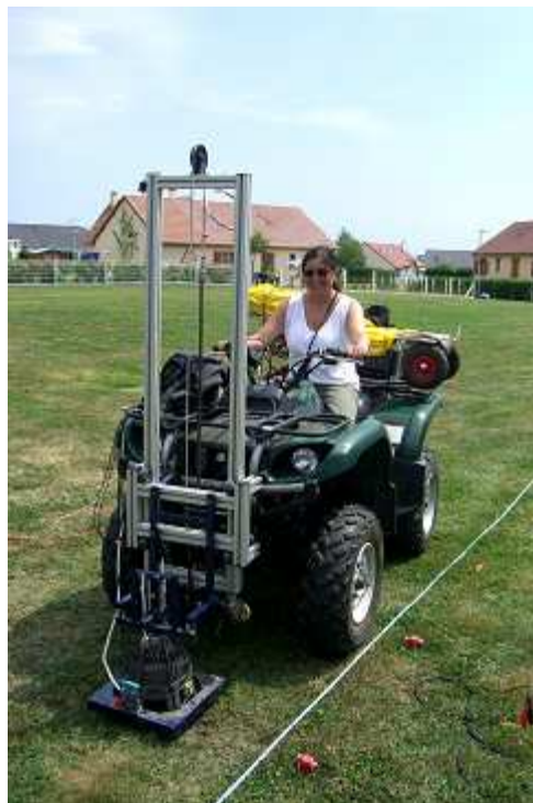
Figure III.14 : Véhicule tout terrain (quad) avec la source Vib-PP.
