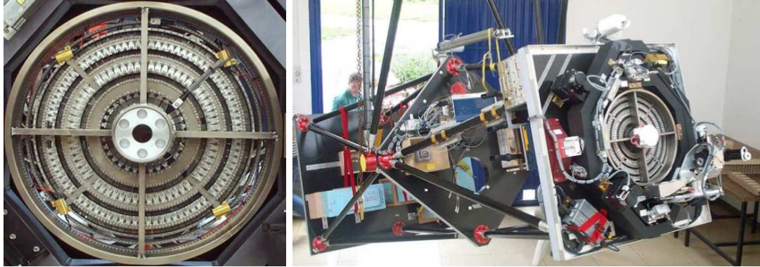
FIGURE 1.12 – A gauche : Photographie de la lentille CLAIRE. Pour gagner en compacité, les cristaux sont successivement collés sur les deux faces de la lentille, d'un anneau à l'autre. A droite : CLAIRE sur sa nacelle ballon.
