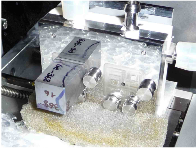
FIGURE 5.7 – Photographie du montage utilisé pour mesurer les angles d'asymétrie. Les deux séries de plots et contacts ponctuels latéraux sont identiques à ceux employés lors du collage par Thales Alenia Space. Les deux séries de plots ont des positions opposées et correspondent aux deux configurations possibles sur le module (en quinconce Fig. 5.1 à droite). Un flux d'air constant est aspiré du trou central et maintient le cristal par effet Venturi sur les plots en inox, usinés au tournage diamant.
