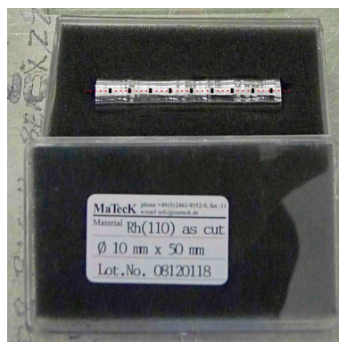
FIGURE 4.20 – Photographie du cristal de rhodium, fabriqué par la société Mateck. Il mesure 50 mm de long et 10 mm de diamètre. Les deux faces aux extrémités du cristal sont parallèles aux plans 220. Les rectangles noirs représentent les neuf zones du cristal qui ont été mesurées, avec une collimation de 1 mm de haut et 0.5 mm de large.
