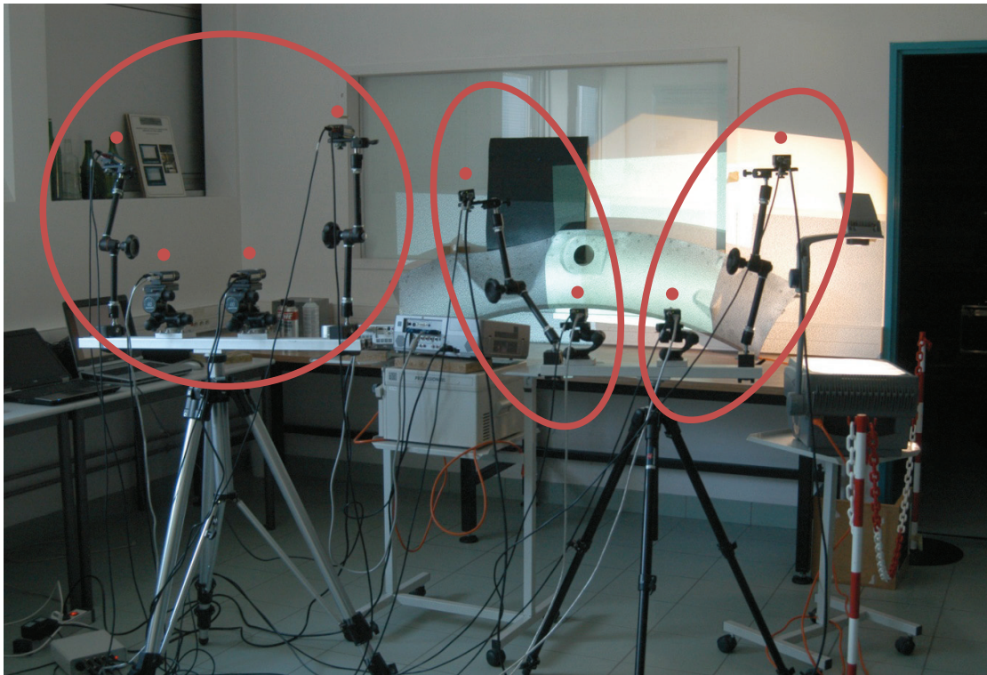
Figure 5. 18- Stratégie de gestion du système multi caméras par grappe et bancs stéréo recalés
