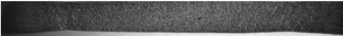
**FIGURE 4.10 :** Observation de la multistriction sur l'éprouvette plate sollicitée en traction rapide.
