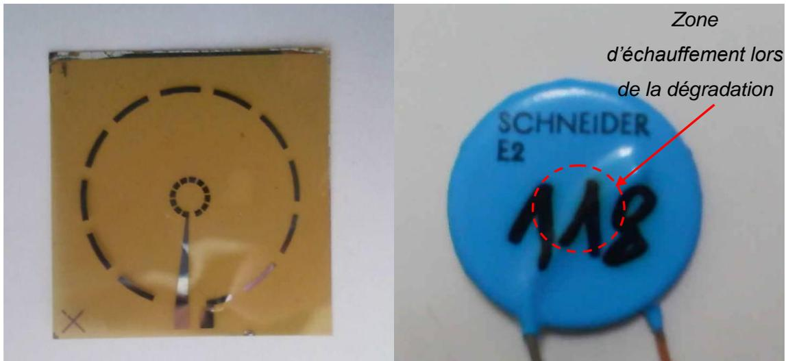
**Figure 80** : Premier niveau, contacts aluminium, d'un capteur pour CTP sur Kapton® souple d'épaisseur 25 $\mu$ m.
