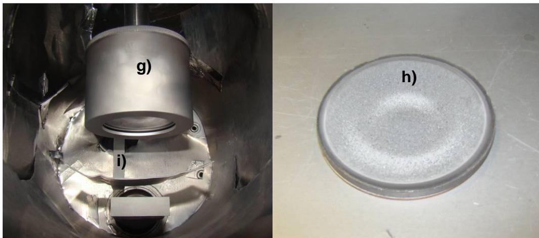
**Figure 21** : g) Cathode ONYX-2, h) cibles de pulvérisation et i) cache de prépulvérisation.
