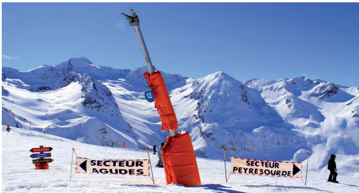
Photo 3.7 : Un enneigeur situé à la liaison des secteurs Agudes et Peyresourde, formant le domaine skiable de Peyragudes (cliché : Maison de Peyragudes, date inconnue). Le basculement entre les deux secteurs du domaine skiable, au niveau d'une zone de crête où la neige peut être soufflée par le vent, est garanti par la production de neige artificielle. La particularité du domaine de Peyragudes est de s'étendre sur deux départements : Hautes-Pyrénées (versant Peyresourde) et Haute-Garonne (versant Agudes).
