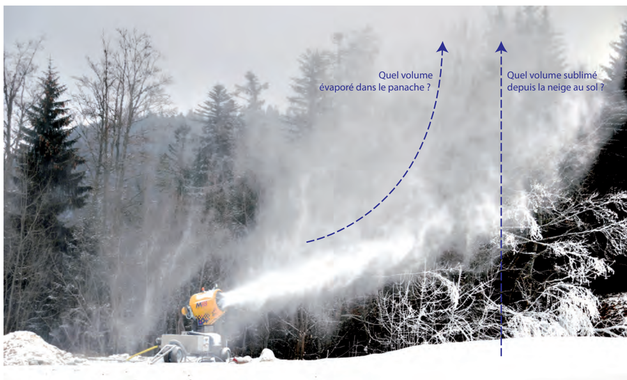
Photo 3.23 : Evaporation et sublimation liées à la production de neige ? (cliché : P. Paccard, le 15/12/2009, Saint-Pierre-de-Chartreuse, Isère). Un coup de vent au moment même de la prise de la photographie donne l'impression que 100 % de la neige produite s'évapore dans l'atmosphère... Ce n'est évidemment pas le cas !
