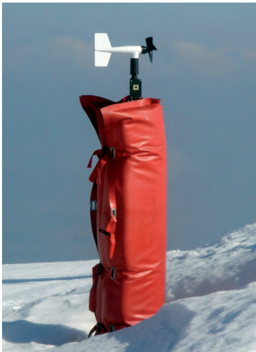
Photo 3.19 : Un des anémomètres du réseau de production de neige Villard-de-Lans, Isère (cliché : P. Paccard, le 05/04/2009)
