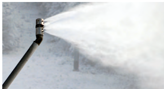
Photo 3.14 : Tête d'enneigeur bi-fluide à mélange externe (cliché : P. Paccard, le 15/12/2009)
