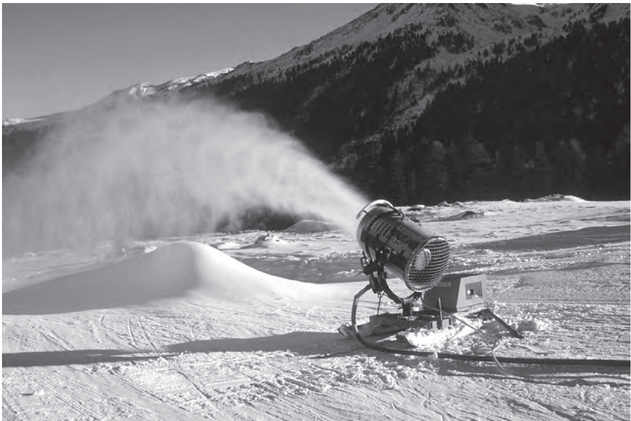
Photo 1.1 : Usage de l'eau pour les sports d'hiver : enneigement artificiel à Tortin (Nendaz, Valais, Suisse) en novembre 1998 (cliché : E. Reynard, 1998 in Reynard, 1999, planche XVI). Enneigreur mono-fluide monté sur patins.
