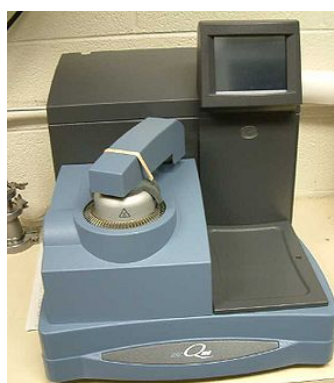
FIG. 2.15 – Schéma de principe de la DSC par flux de chaleur (gauche), photographie de la DSC (droite)
