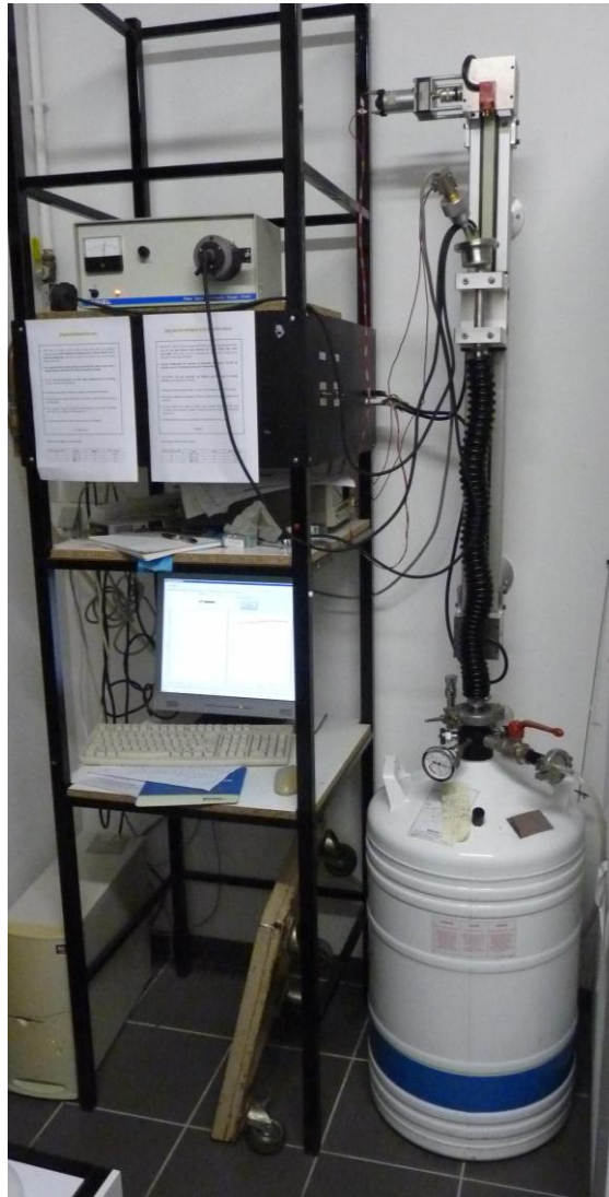
Figure 126 : Dispositif expérimentale de réflexion diffuse à basse température
