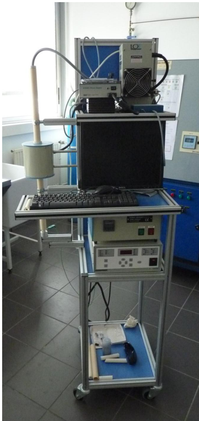
Figure 127 : Dispositif expérimentale de réflexion diffuse à haute température
