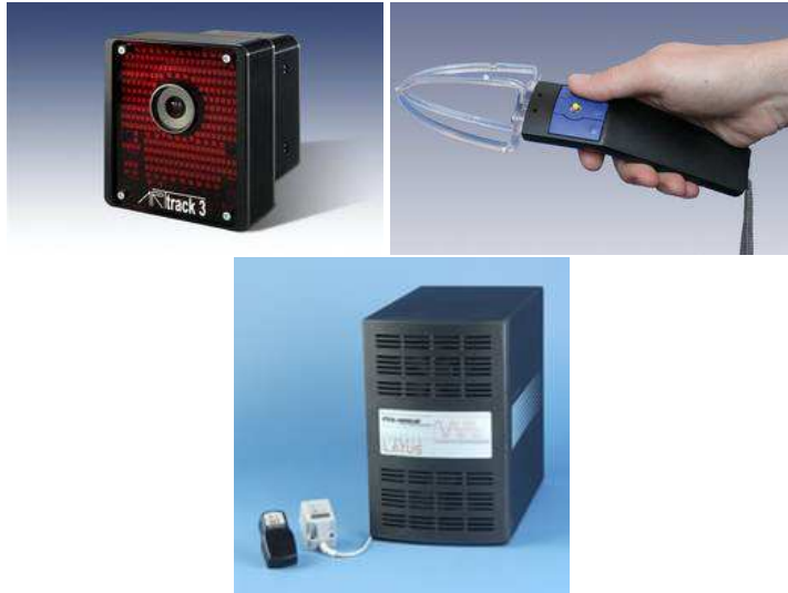
FIG. 1.15 – Suivi vidéo infrarouge avec une caméra et des marqueurs fixés sur un dispositif d'interaction de type "baguette", et tracking électromagnétique.
