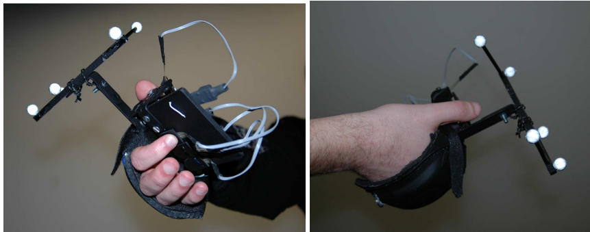
FIG. 4.3 – Capteurs FSR sous l'index, le majeur et l'annulaire (gauche). Capteur FSR sur le côté du pouce (droite)
