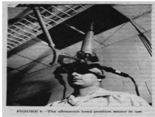
FIG. 1.13 – Système Ultimate Display mis au point par Sutherland.
