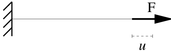
FIG. 1.2: Poutre à rigidité uniforme en traction.
