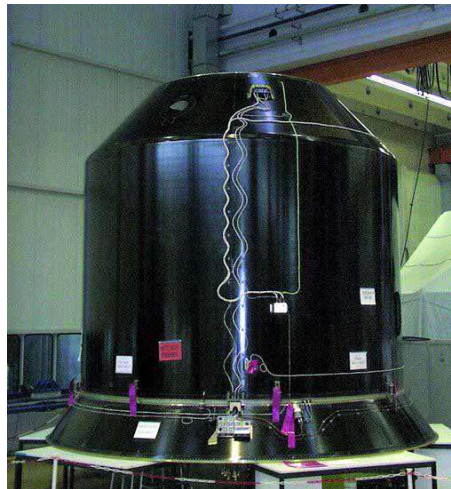
FIG. 2.8: Le support de satellites Sylda 5.
