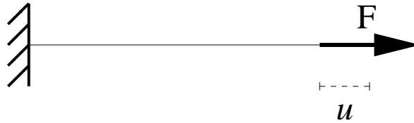
FIG. 4.4: Barre en traction.
