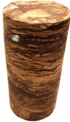
FIG. 3.1 : Carotte de roche de couverture d'un diamètre de 86 mm pour une longueur de 180 mm.
