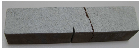
FIG. 3.14 : Echantillon rompu suite à l'amorçage et à la propagation d'une fissure non détectée.
