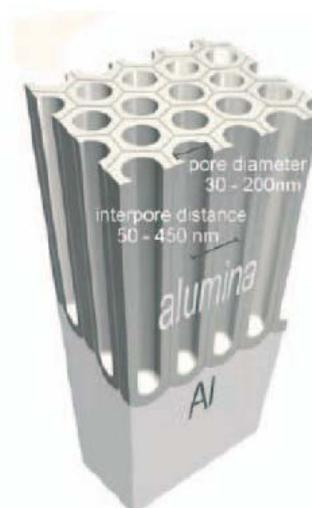
**Figure 2-1 schéma d'un réseau nanoporeux d'alumine. [3]**
