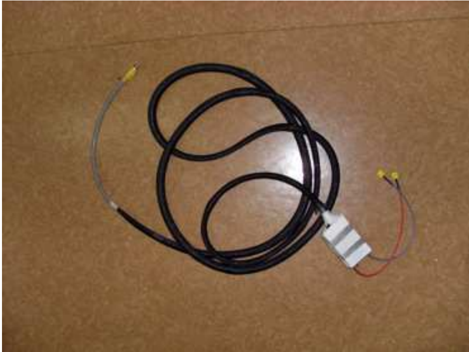
FIGURE 2.1 – Les transducteurs acoustiques insert-earphones avec le système de blindage que nous avons confectionné. Le son est véhiculé depuis l'audiomètre jusqu'aux transducteurs où la vibration de la membrane génère le stimulus à la base des deux tubes d'air. L'onde de pression acoustique se propage alors jusqu'aux oreilles du sujet, en passant à travers un filtre acoustique (en noir avant les earplugs jaunes) imitant les caractéristiques du pavillon de l'oreille externe. L'avantage des inserts est d'éloigner la source de rayonnement électromagnétique des électrodes en électrophysiologie. Toutefois, selon les dispositifs expérimentaux, cette précaution peut s'avérer insuffisante. Nous avons encastré les fils, ainsi que l'habitacle des inserts dans une cage de Faraday (tresse métallique et boîtier en aluminium), ne laissant dépasser que les tubes de caoutchouc.
